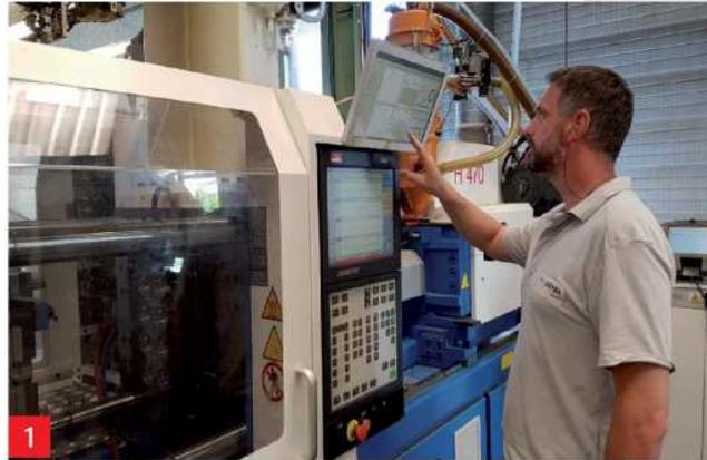
1 - ComoNeo est le système de surveillance de processus pour une efficacité maximale lors du moulage par injection.
